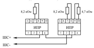
Схема подключения извещателей "ИП212-34" ("ДИП-34")
