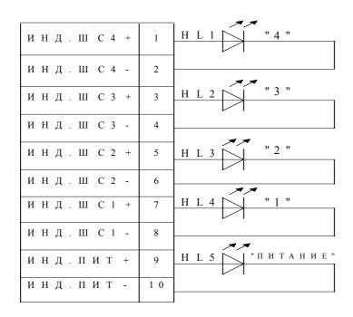
Примечание Контакты 2,4,6,8,10 разъёма XS6 объединены на плате прибора. Индикаторы HL1-HL5 – типа АЛ 307БМ.
